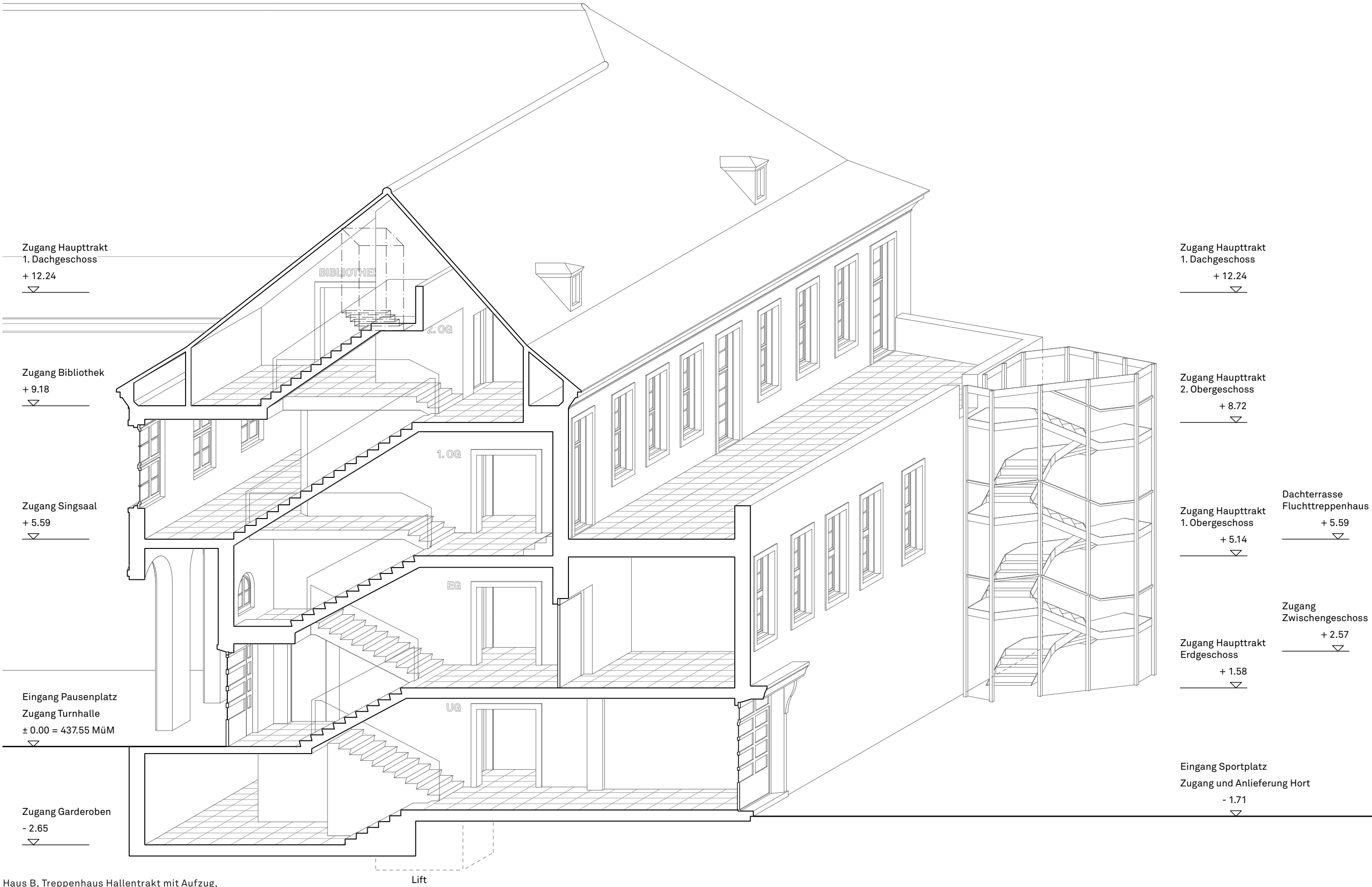
Haus B, Treppenhaus Hallentrakt mit Aufzug, Schnittaxonometrie 1:100
