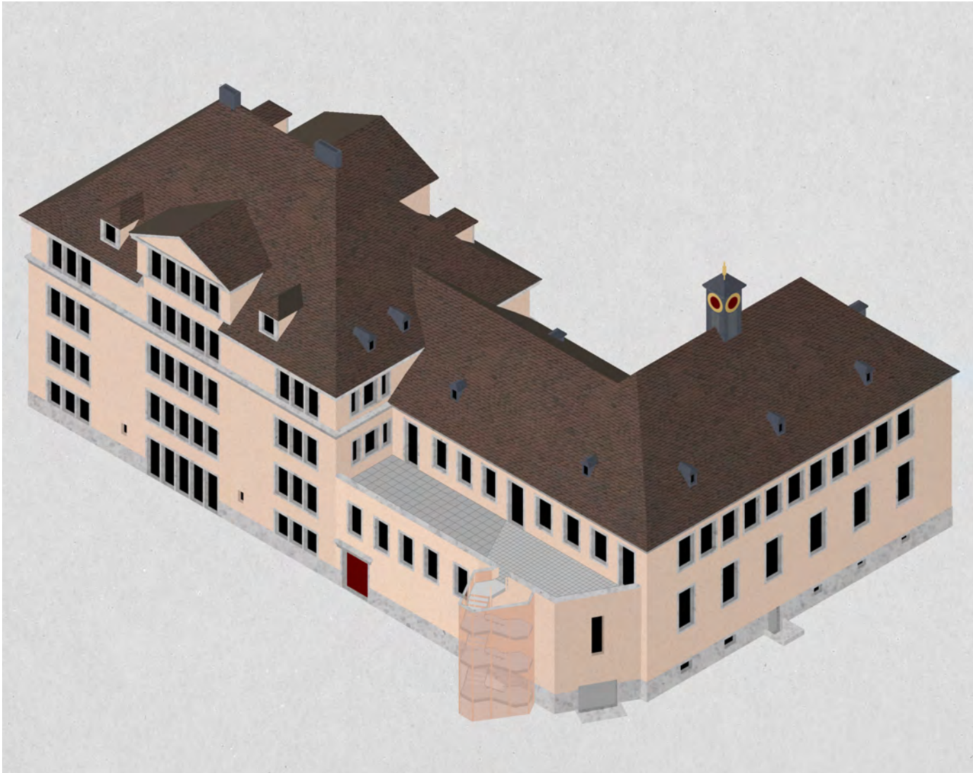
Haus B, Fassaden mit neuer Aussenfluchttreppe, Axonometrie 1:400
